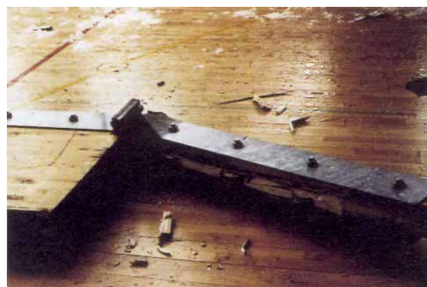
Figure 27 – Assemblage d'angle de portique fissuré
