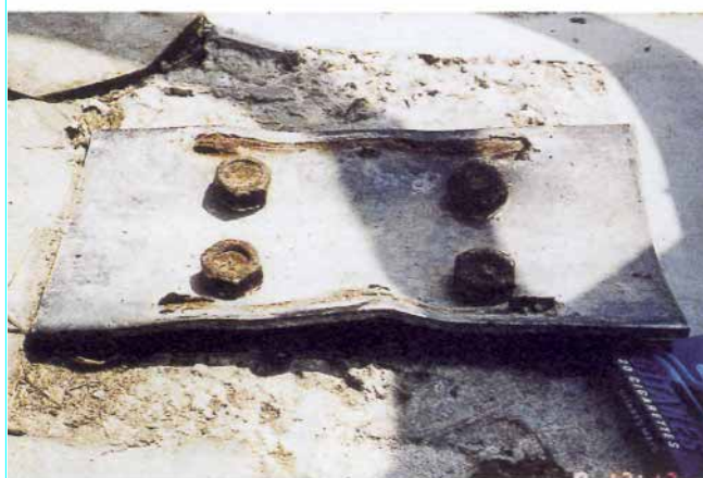
b) rupture de soudure de platine
