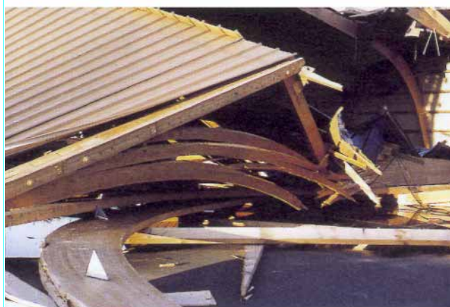
c) arc en lamellé-collé brisé
