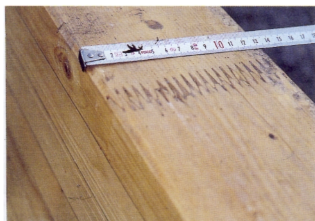
(c) défaut d'aboutage affectant une poutre identique à celle de la figure 26a
